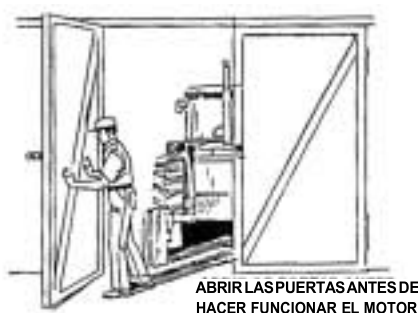
FIG. 33 Airear suficientemente el local de arranque antes de iniciar dicha operación*.
